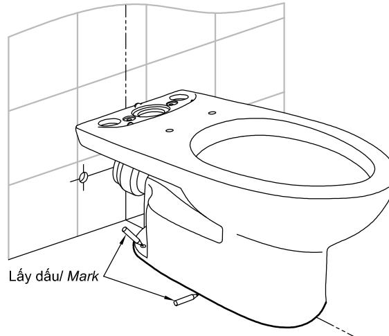
3. Khoan lỗ cố định bàn cầu và lắp van dừng./ Drill the holes fixed the toilet then installation the stop valve.
