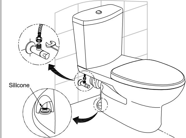
10. Làm kín chân bằng silicone./ *Close leg by silicone.*
