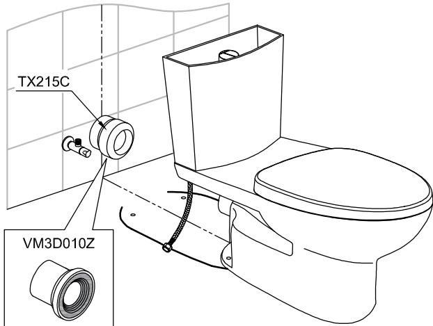
8. Lắp vít cố định thân cầu . / *Install the screw to fix the toilet*
