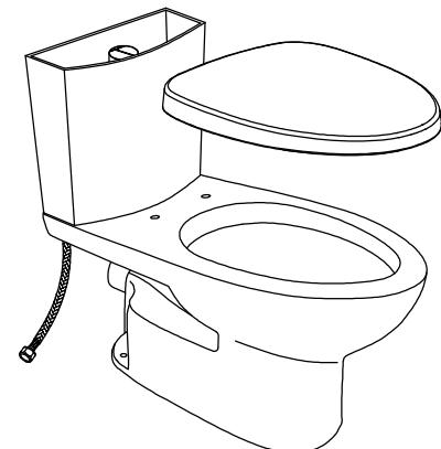
7. Lắp đặt bàn cầu xuống sàn./ *Install the toilet onto the floor.*
