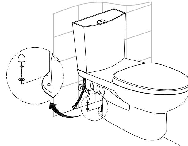
9. Lắp dây cáp với van dừng.
