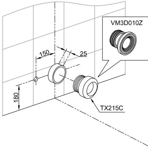
2. Đặt bàn cầu vào vị trí lắp đặt, lấy dấu lỗ cố định và chân./ Place the toilet into installation position then mark fixed holes and toilet leg.
