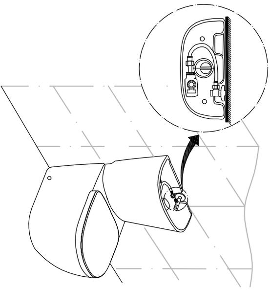
11. Lắp vít cố định thân cầu./ Install the screw to fix the toilet.
