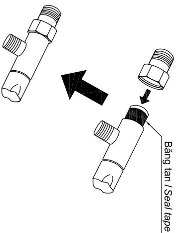
Chú ý: Phải cuốn băng tan khi lắp ráp nút nối với van dùng.
