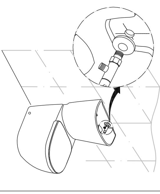
10. Lắp dây cấp với van dùng.
