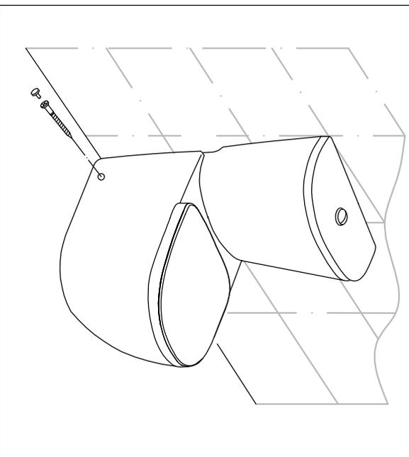
12. Làm kín chân bằng silicone./ Close leg by silicone.
